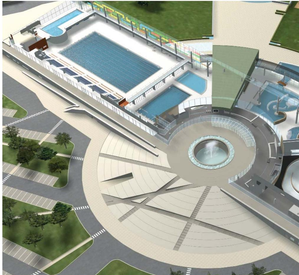
Das Wettkampfbecken (50 m x 25 m, Edelstahl, ruhig, hell) ist das Herzstück des Projekts und das Wahrzeichen der Anlage. Das Becken wurde so konzipiert, dass die Durchführung nationaler und internationaler Wettkämpfe möglich ist, was insbesondere durch die separate Anordnung, ein zusätzliches 25-m-Aufwärmbecken und die Möglichkeit, die Zuschauerränge auf 2.000 Plätze zu erweitern, gewährleistet wird.
